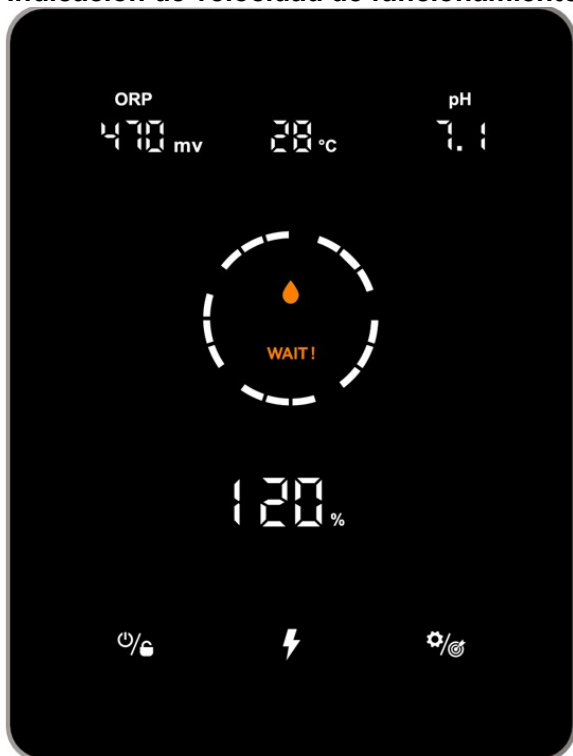
Indicación de velocidad de funcionamiento
